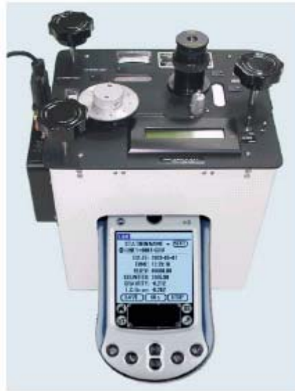
Figura III.10: Foto del gravímetro La Coste & Romberg tradicional actualizado con sistema electrónico de lectura.
