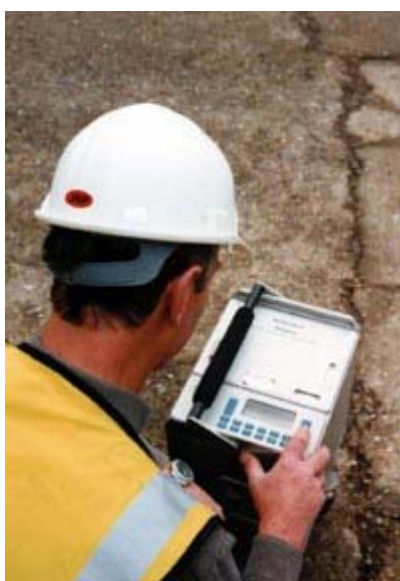
Figura III.12: Foto de un gravímetro Scintrex Autograv CG-3.
