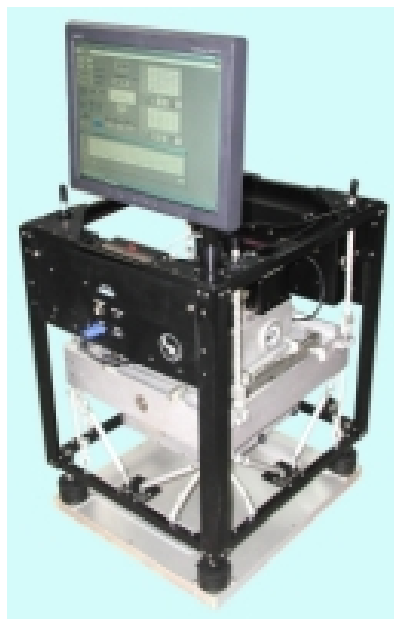
Figura III.3: Gravímetro en plataforma dinámicamente estabilizada en aire o mar. Producto Air-Sea Gravity System II, desarrollado por LaCoste & Romberg.
