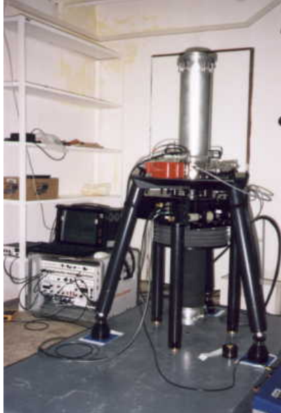
Figura III.2: Foto de un gravímetro absoluto de caída libre FG5 (ver descripción más abajo).
