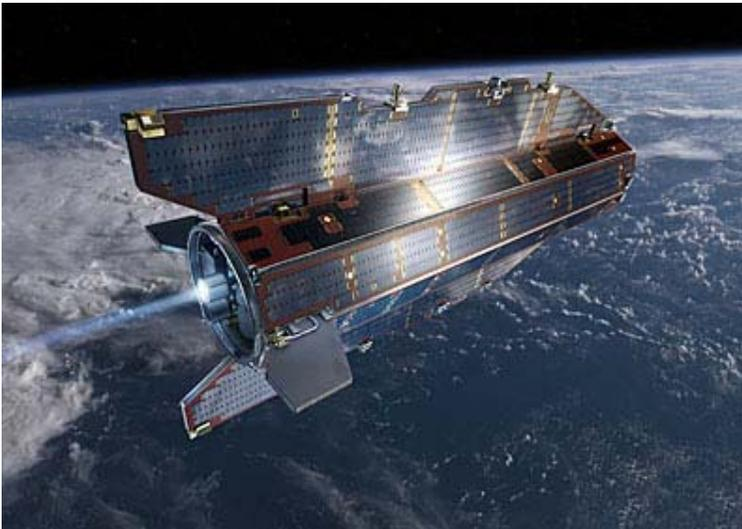
primera vez permitirá obtener el campo gravitatorio a partir de Gradiómetros con un ensamble de 6 acelerómetros triaxiales para medir en órbita los gradientes de gravedad. El satélite GOCE fue lanzado el 17 de marzo de 2009 volará en una órbita extremadamente baja de 250 km de altitud.
